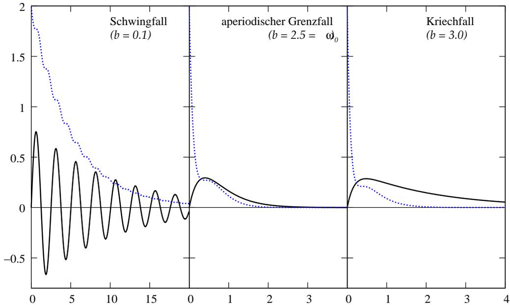
Abbildung 1: Ort  $x(t)$  (—) und Energie  $E_{\text{mech}}(t)$  ( $\cdots$ ) eines gedämpften harmonischen Oszillators für verschiedene Dämpfungsparameter  $b$ . Feste Parameter:  $m = 1 \text{ kg}$ ,  $\omega_0 = 2.5 \text{ s}^{-1}$ ,  $v_0 = 2 \text{ m/s}$
