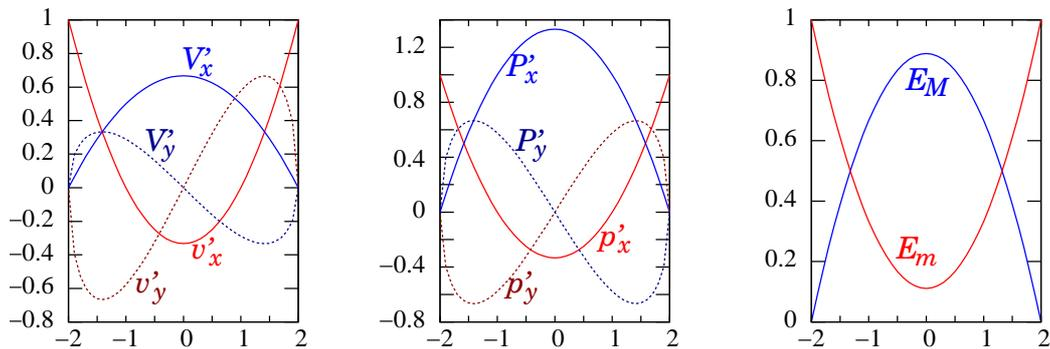
Abbildung 2:  $x, y$ -Komponenten der Geschwindigkeiten  $\vec{v}'$ ,  $\vec{V}'$  (links) und der Impulse  $\vec{p}'$ ,  $\vec{P}'$  (Mitte) für  $m = 1$ ,  $M = 2$ ,  $p = 1$  und  $R = 1$  in Abhängigkeit von  $b$ . Rechts sind die Energien  $E_m = p^2/m$  und  $E_M = P^2/P$  der Kugeln in Abhängigkeit von  $b$ .
