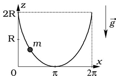
Eine Perle gleitet unter Einfluss der Schwerkraft  $g\vec{e}_z$  reibungsfrei auf einem Draht. Dieser ist als Zykloide geformt, d.h. die Bahn der Perle genügt den Gleichungen
