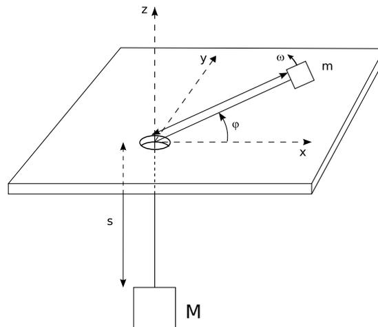
Eine Masse  $m$  rotiert reibungslos auf einer Tischplatte. Über einen Faden der Länge  $l$  ( $l = r + s$ ), der durch ein Loch in der Platte verläuft, ist  $m$  mit einer anderen Masse  $M$  verbunden. Es ist die Bewegung von  $m$  und  $M$  unter Einfluß der Schwerkraft  $g\vec{e}_z$  zu untersuchen.
