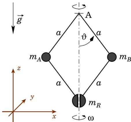
Ein Fliehkraftregler ist ein mechanisches Instrument, das in vielen technischen Anwendungen eingesetzt wurde (wird). Die Arbeitsweise beruht darauf, dass sich bei der Rotation von zwei Massen an gelenkig befestigten Stangen eine von der Rotationsgeschwindigkeit abhängige Gleichgewichtsposition einstellt. Mittels geeigneter Vorrichtungen, die auf diese Positionen ansprechen, kann man in Abhängigkeit von der Rotationsgeschwindigkeit die Arbeitsweise von Maschinen regulieren.
